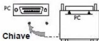
Se sulla stessa porta parallela viene utilizzata una stampante, è sufficiente inserirla nella chiave di protezione del software. In tal caso può essere necessario accendere la stampante per consentire il riconoscimento della chiave di protezione del software.
